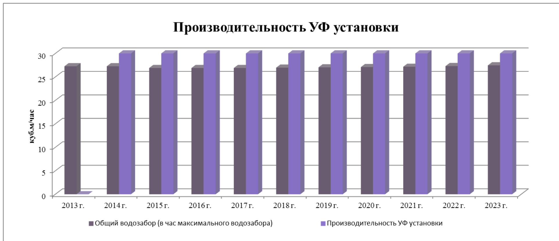
Рисунок 8 - Производительность очистных сооружений
